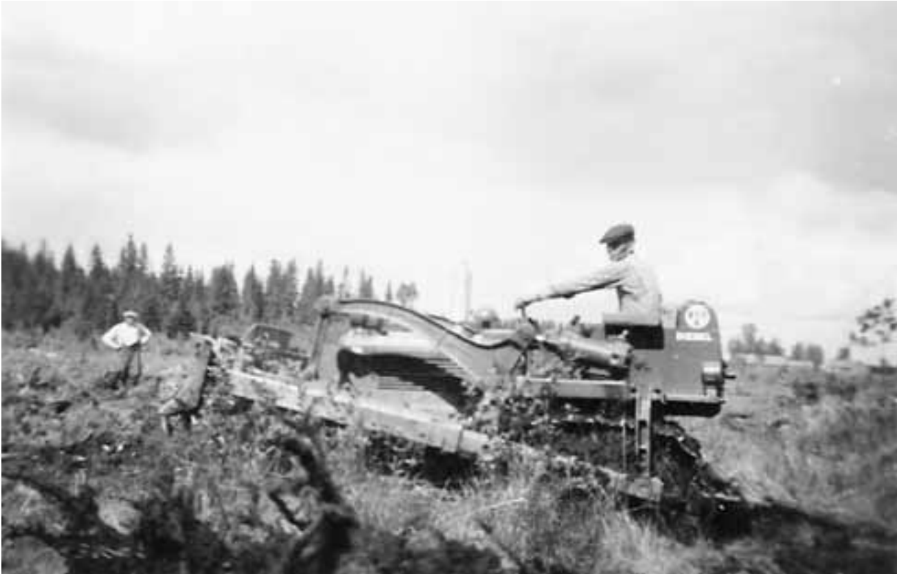
Vampulassa ei ollut ns. kylmiä tiloja ollenkaan, mutta monet Vampulaan pysyvästi sijoitetut evakot laajensivat peltojaan uudisraivauksilla. Kuvassa Pellonraivaus Oy:n telaketjutraktori työntämässä kantoja kasalle. Kuva Erkki Poutasen kokoelmasta.
